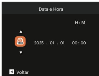
4. Prima o botão [ ◀🕒 ]/[ ►⚡ ] para seleccionar o bloco a ajustar: A hora é exibida no formato YYYY.MM.DD/HH:MM.
