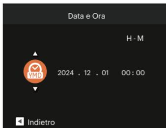
4. Premere il tasto [ ◀️ 🗑️ ]/[ ▶️ ⚡ ] per selezionare il blocco da regolare: L'ora viene visualizzata in YYYY. MM.DD/HH:MM.
