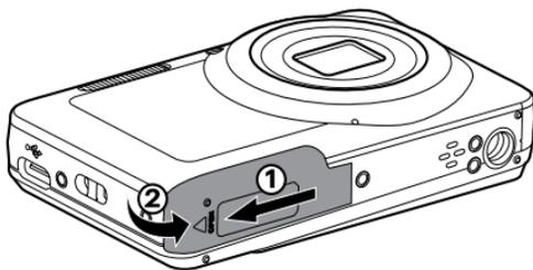
2. Inserire la batteria osservando la polarità corretta. Usare il lato della batteria per premere l'otturatore come mostrato, permettendo alla batteria di bloccarsi correttamente in posizione.
