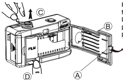
Presione el pestillo (A) en la dirección de la flecha y abra la puerta trasera de la cámara (B). Levante la manivela de rebobinado de la película (C) y coloque un nuevo rollo de película en el compartimento de la película.
