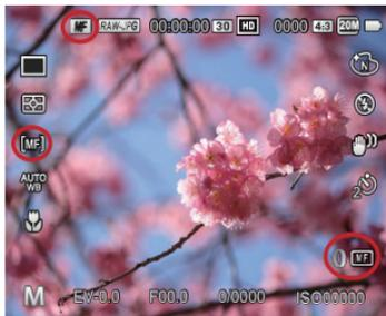
2. Se o anel de funcionamento da lente é operado ou rolando o jog dial, o enquadramento de alargamento da focagem irá aparecer no LCD. Após a focagem clara ser atingida através do ajuste manual, pressione o botão para fechar o enquadramento de alargamento da focagem. A câmera retornará para a tela de fotografar normal. Semi-pressionando o botão do obturador não terá efeito; você necessita de pressionar totalmente o botão do obturador para tirar uma foto normal.
