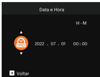
4. Prima os botões [ ◀🕒 ]/[ ►⚡ ] para seleccionar o bloco a ajustar: A hora é exibida no formato YYYY. MM.DD/HH:MM.
