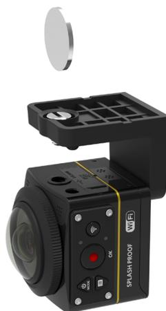
2. Montare nel supporto adesivo per casco a L come mostrato in figura e serrare la vite.
