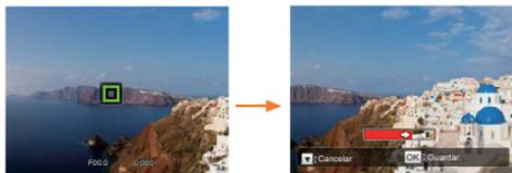
4. Gire la cámara de acuerdo a la dirección fijada. Cuando el rango de rotación cumple con la configuración interna de la cámara, el cuadro de diálogo de progreso a lo largo de la flecha indicadora cambia parcialmente al color rojo. Cuando cambia completamente al color rojo, la toma en modo panorámico está completa.
