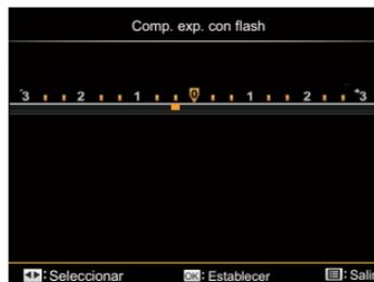
La compensación de la exposición del flash no se puede ajustar si el flash se ha desconectado o cerrado.
