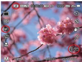
2. Se o anel de funcionamento da lente é operado ou rolando o jog dial, isto ampliará o LCD no tema. Após a focagem clara ser atingida através do ajuste manual, pressione o botão **SET** para fechar o enquadramento de alargamento da focagem. A câmera retornará para a tela de fotografar normal. Semipressionando o botão do obturador não terá efeito; você necessita de pressionar totalmente o botão do obturador para tirar uma foto normal.
