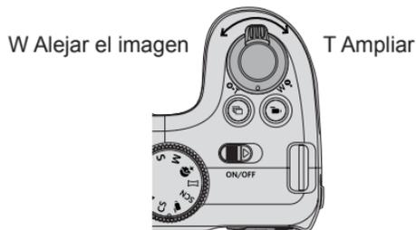
1. Deslice la palanca de zoom para cambiar a 3x3 y 4x4 miniaturas.
