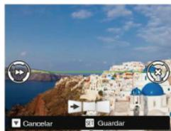
4. Cuando termine de disparar la primera foto, se mostrarán dos iconos en la pantalla LCD en los lados izquierdo y derecho. Cuando mueva la cámara hasta el icono redondo de guía de dirección y el cuadrado de la caja de posicionamiento se vuelva verde, estos se solaparán, y la cámara tomará otra foto automáticamente. Repitiendo los mismos pasos se podrán disparar hasta 4 fotos.
