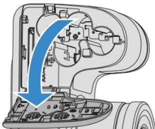
2. Inserte la batería en la ranura de la batería en la correcta posición como se muestra en el diagrama.
