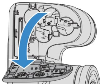
2. Achten Sie beim Einlegen des Akkus auf die richtige Polarität. Der Akku muss soweit in den Schacht eingefügt sein, dass der gelbe Schieber oberhalb des Akkus einrastet und ein Herausfallen des Akkus verhindert. (wie in der Grafik abgebildet)
