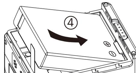
ⓘ Jale con suavidad la cinta hacia arriba para retirar la batería. Al insertar la batería, no doble la cinta bajo la batería.
