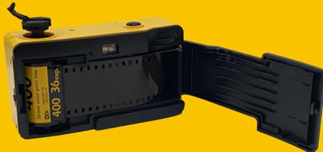
Stellen Sie sicher, dass der Film gegen die Mitte der Kamera liegt und die Hintertür der Kamera geschlossen wird.
